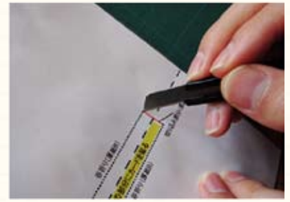
③厚紙Bの上に印刷した組み立て用型紙を当てて、切り込み線に沿ってカッターで切り込みを入れる。
