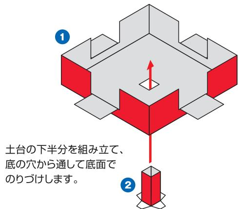
土台の下半分を組み立て、底の穴から通して底面でのりづけします。
