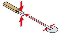
持ち手を組み立てた後、柄の部分をのりしろまで深く差し込み、上下ではさむようにのりつけ。
